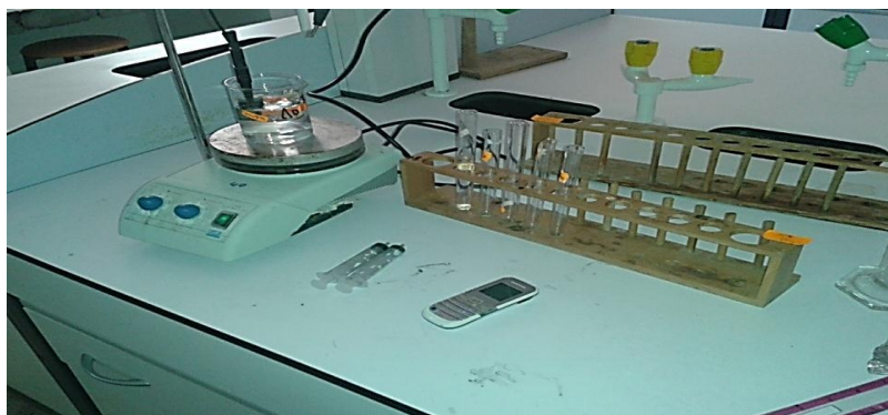
Figure II.3. Schéma de l'installation de la cémentation des ions \text{Cu}^{2+} et \text{Ag}^+ par une plaque de zinc.
