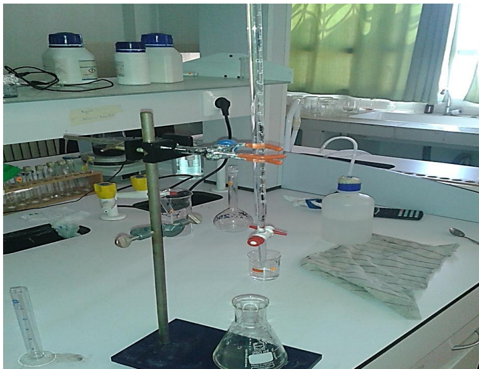
Figure II.8. Montage de la méthode volumétrique.
