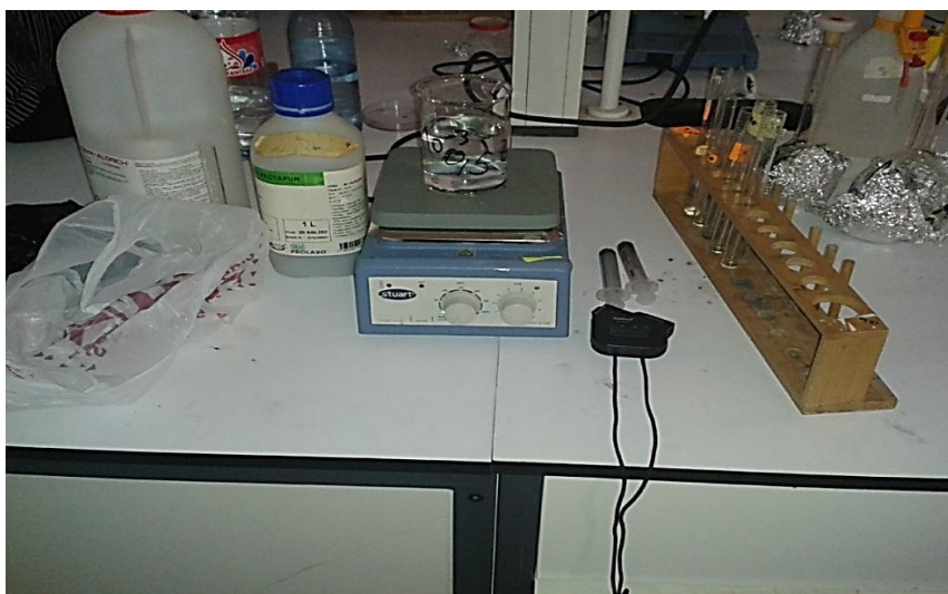
Figure II.2. Schéma de l'installation de la cémentation de l'argent par la poudre de zinc.
