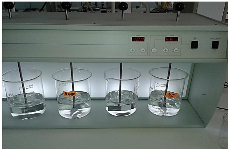
Figure II.1. Schéma de l'installation (floculateur jar test).
