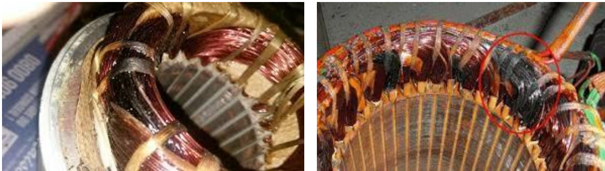
Figure I.15. Exemple de dégâts provoqués par les défauts de courts-circuits statoriques [35],[36].
