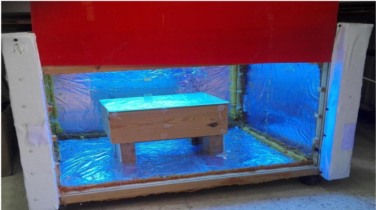
**Figure III.2 :** Chambre des radiations sous Ultra-Violet.
