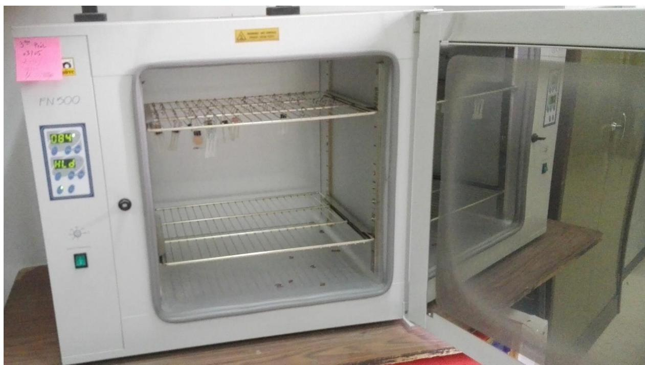
**Figure III.1** : Etuve pour le vieillissement thermique.
