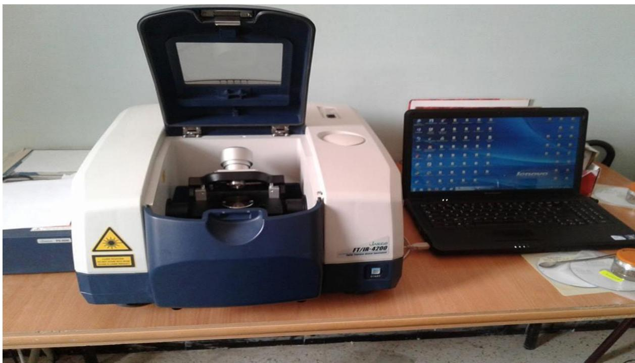
**Figure III.5:** Appareil infrarouge FTIR/ATR.
