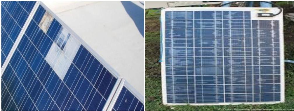
**Figure (II.8) :** Défaut de la délamination.
