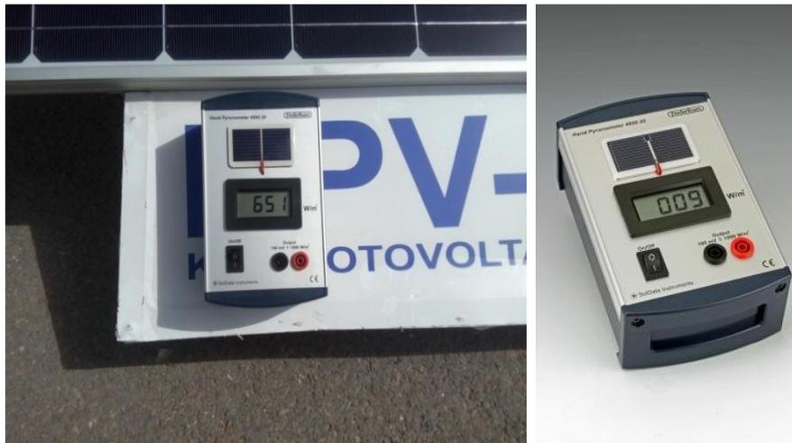
Figure (III.6): Pyranomètre 4890.20.
