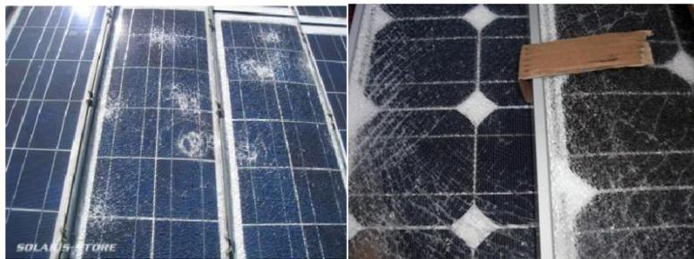
**Figure (II.6):** Défaut de fissuration d'un panneau PV.
