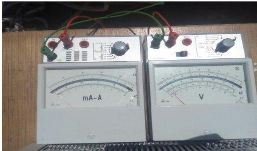
**Figure (III.5) :** Voltmètre et Ampèremètre utiliser lors de l'expérience.
