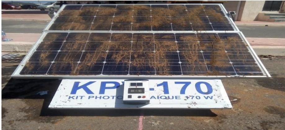
**Figure (III.26) :** Ombrage par salissure.
