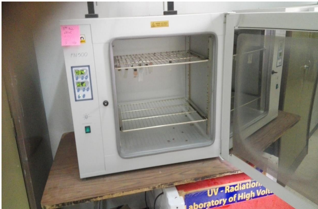
Figure. III.13. L'étuve à convection électrique utilisée pour le vieillissement thermique
