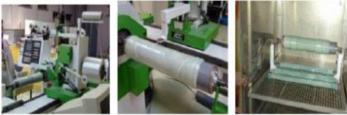
Figure.I.25. Fabrication des tubes, (a) machine d'enroulement filamenteuse, (b) phase d'enroulement et (c) cuisson en étuve
