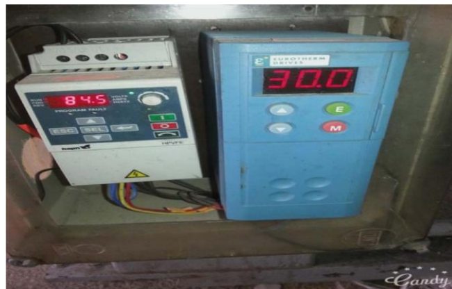
Figure. III.5. Réglage des fréquences de rotation de mandrin et la vitesse de translation du chariot.
