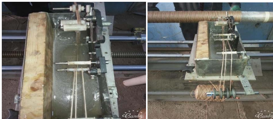
Figure. III.6. Fibres passant dans le bain de résine
