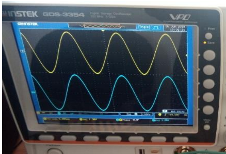
Figure III. 5: l'oscillogramme des tensions U_R et U_b .
