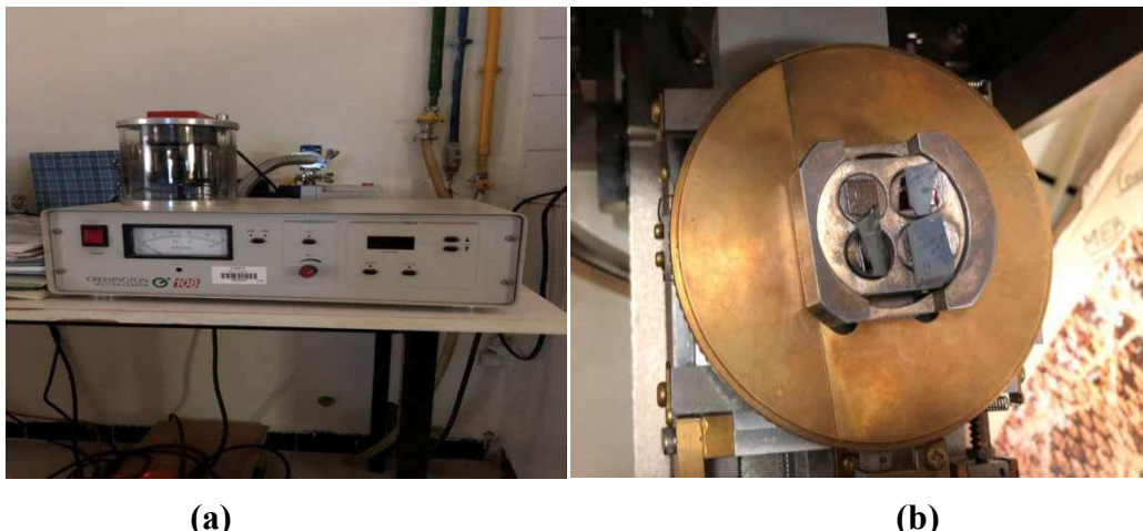
Figure 3. 2: (a) Métalliseur par pulvérisation cathodique de marque Cressigton Sputter Coater 108, (b) Echantillons métallisés en Palladium-Or (placés sur un porte échantillons MEB).
