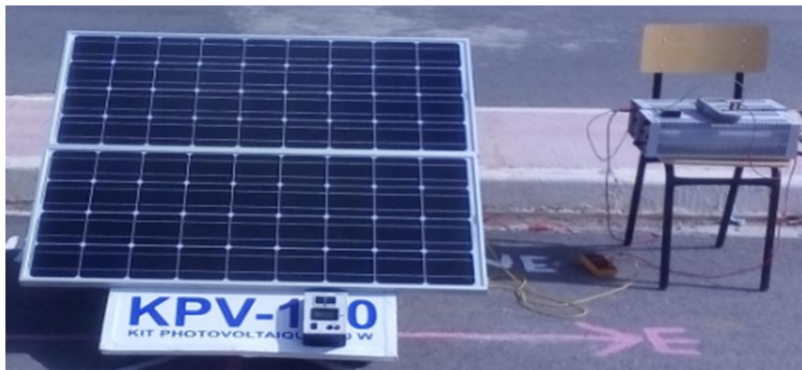
Figure (III.3) : Panneau solaire photovoltaïque modèle STP085B-12/BEA
