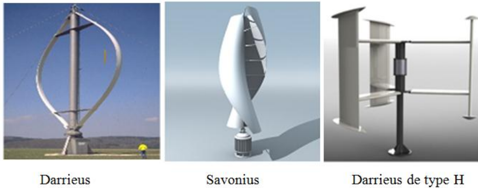
Figure 1.4 : technologie éolienne à axe vertical.
