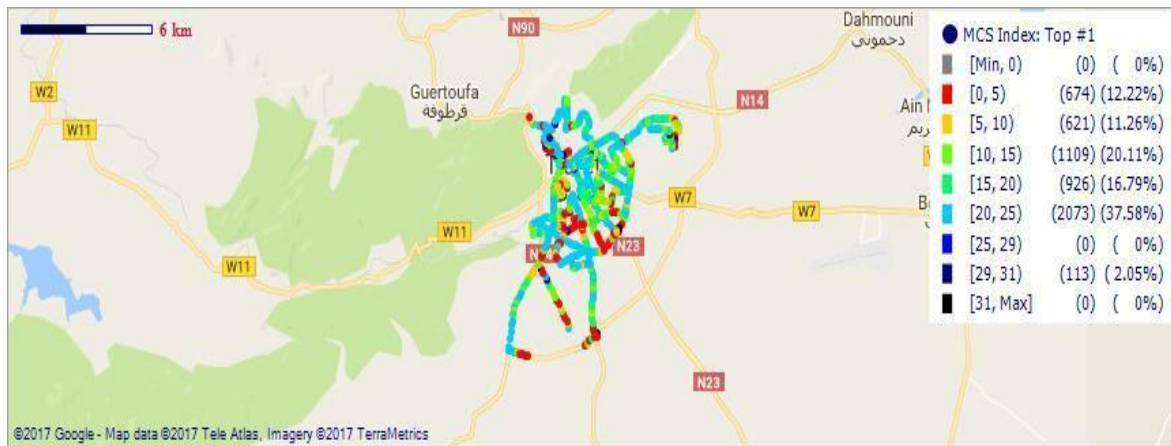
Figure III.24 : Modulations du réseau LTE utilisées pour le lien montant et leurs qualités
