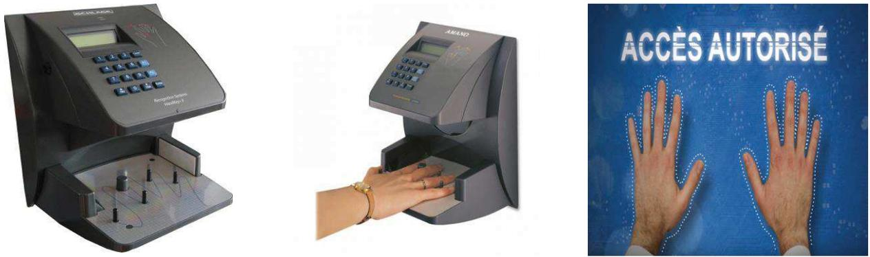
Figure 1. 9 : Système biométrique basé sur la géométrie de la main.
