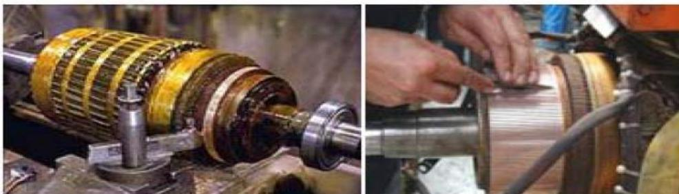
**Figure(III.5) :** Rotor (induit) de la machine à courant continu [16].
