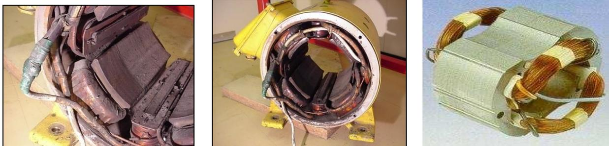
**Figure(III.4) :** Stator (inducteur) de la machine à courant continu [16].
