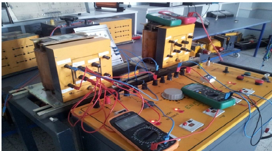
Figure III.3 :Montage réalisé en essai en court-circuit.
