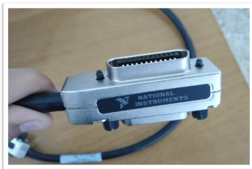
Figure 13.c : photo réelle des connecteurs du câble GPIB. [13]
