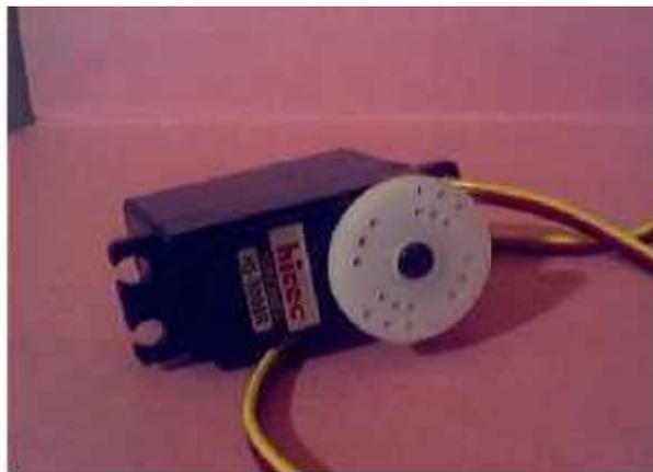
Figure (1.1) : Représentation d'un servomoteur.
