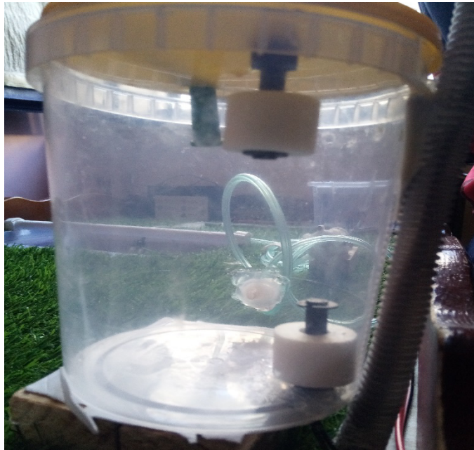
Figure 3-25 : Emplacement de flotteur dans le réservoir.
