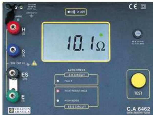
Figure.3.3 : une vue sur l'appareil de mesure de prise de terre
