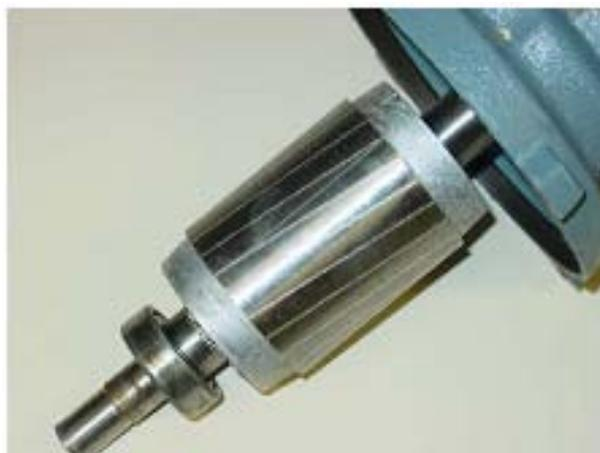
**Figure II.3 :** Rotor à cage
