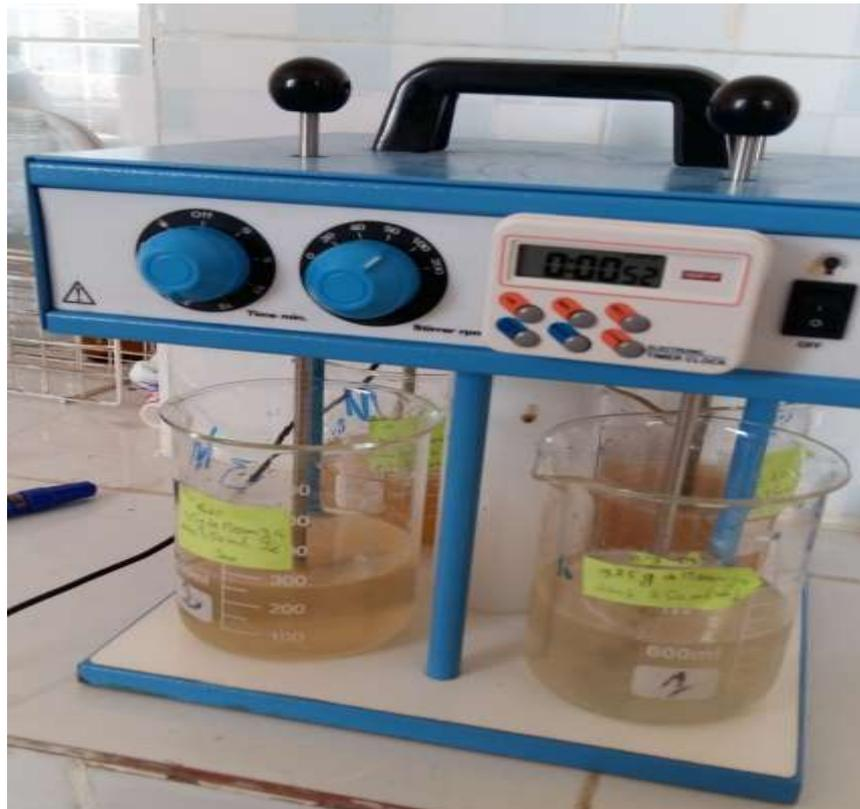
**Figure V.3** : Jar test à quatre rampes.
