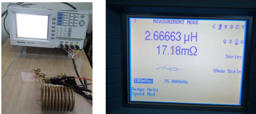
Figure IV.12 : Relever de la valeur de l'inductance et la résistance interne de l'inducteur.
