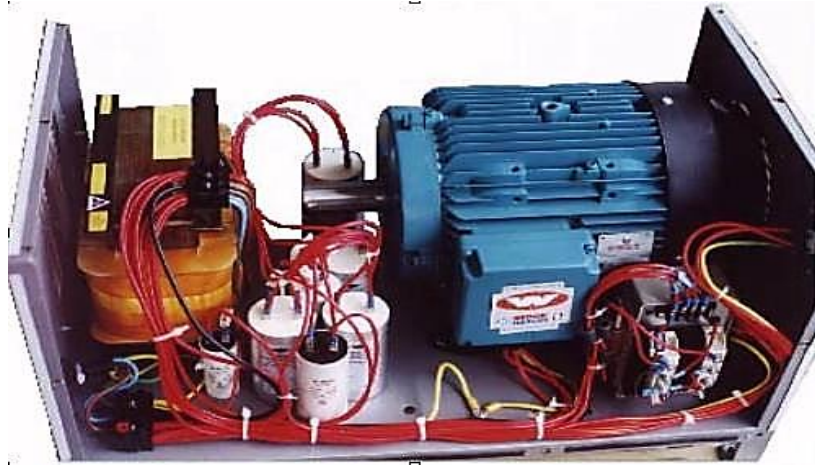
Figure II.2 : Photo réelle d'un convertisseur à groupe rotatif.
