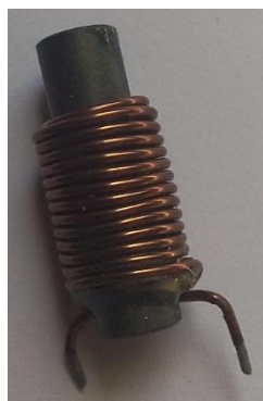
Figure IV.9 : Bobine de 25 \mu\text{H} avec noyau de fer.
