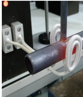
Figure I.17 : Soudage de deux pièces métalliques par induction.
