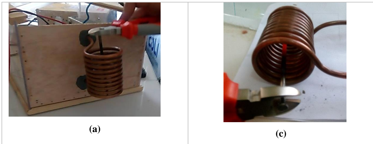
Figure IV.17 : Essai en charge avec un clou à broche.
