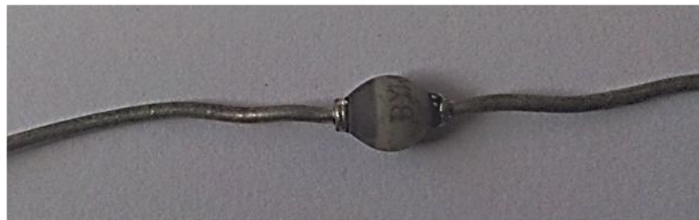
Figure IV.8 : Diode rapide BYW 36
