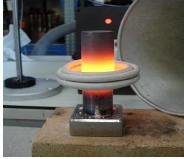
Figure I.20 : Brassage électromagnétique d'alliages métalliques.
