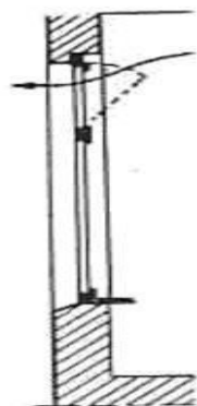
Figure (2.1) : fenêtre à imposte a bascule..
