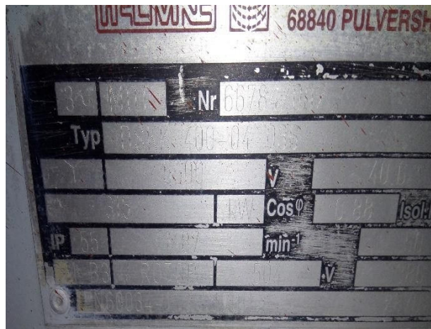
Figure 2. 5 Plaque signalétique du ventilateur « atelier broyage ciment »
