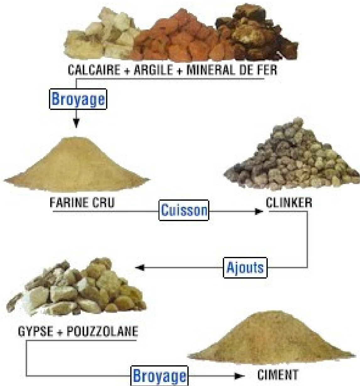
Fig 1.2 Processus de fabrication du ciment
