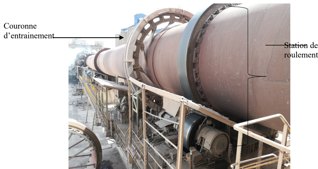
Figure 4.3 La couronne d'entraînement et une station de roulement du four de la SCSEG
