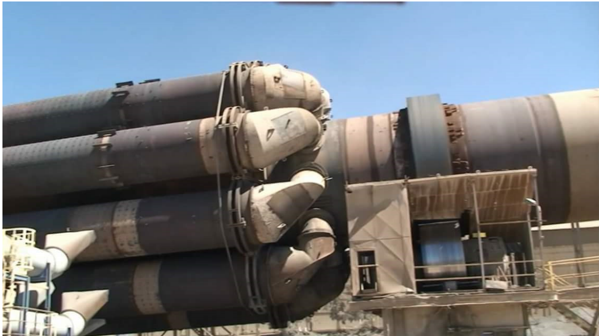
Figure 4.6 Refroidisseur à ballonnets de la SCSEG
