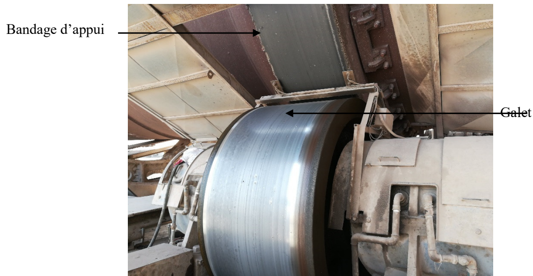
Figure 4.4 Usure non uniforme d'un galet de support du four de la SCSEG
