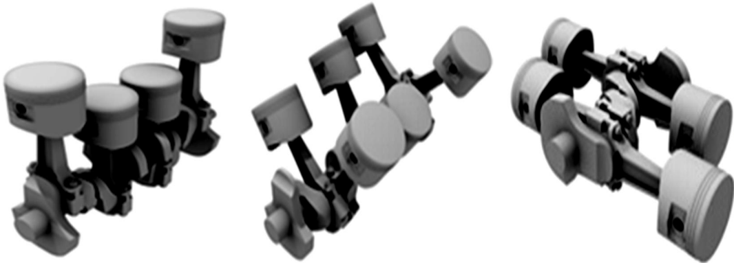
Figure II.10: disposition des cylindres : Moteur en ligne, Moteur en v, Moteur boxer, de droite a gauche.
