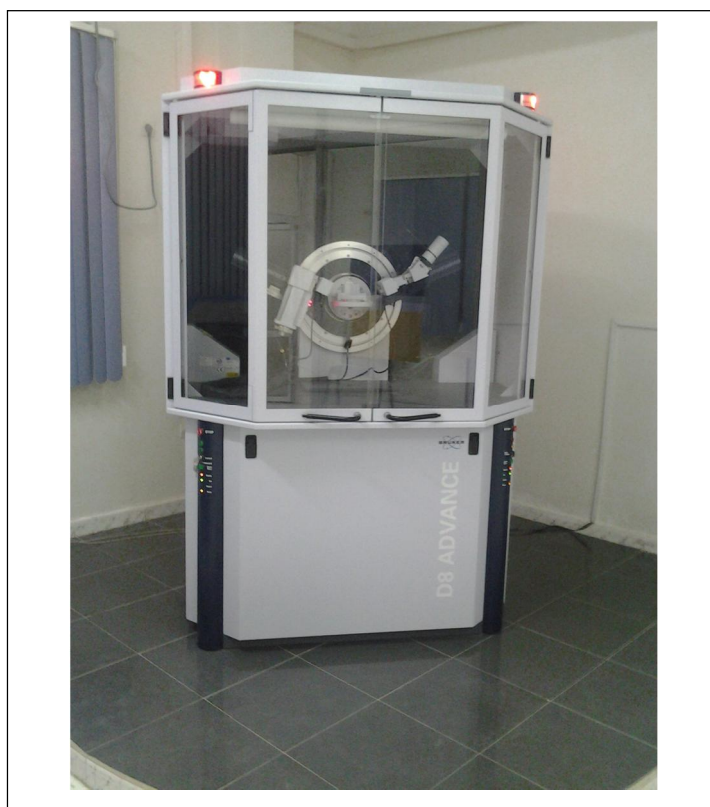
Figure III.2 : Photographie du diffractomètre Bruker D8 Advance (Laboratoire de DRX, Université Mohamed Khaider, Biskra).
