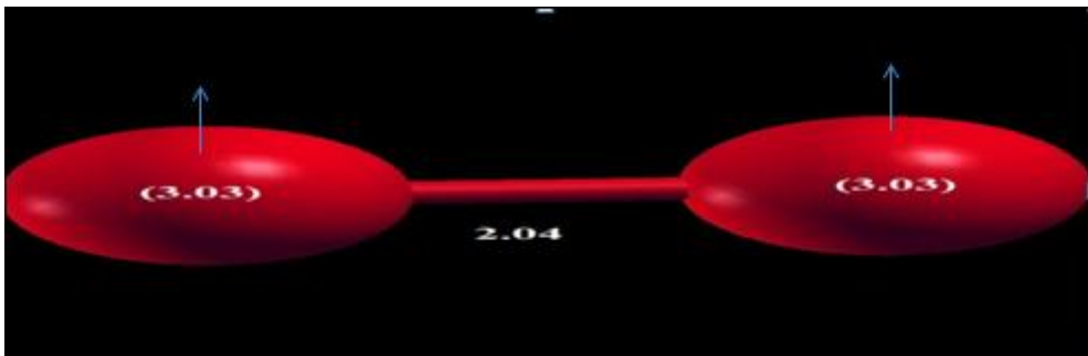
Fig. 3.3 – Structure géométrique et magnétique de l'agrégat Fe 2 . La distance interatomique (Å) et le moment magnétique ( \mu_B ) y sont représentés
