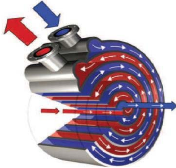
Figure I. 8 : Échangeur à spirale [1]
