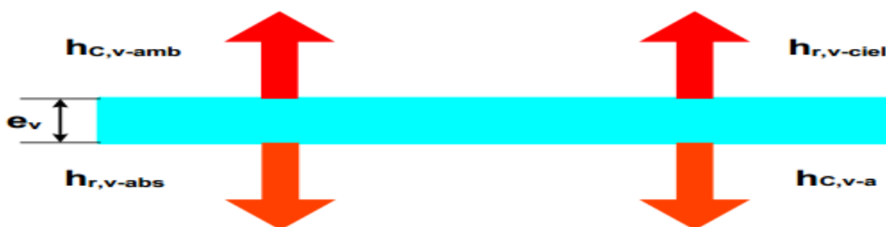
Figure III.6 : Echange thermique au niveau de la vitre.
