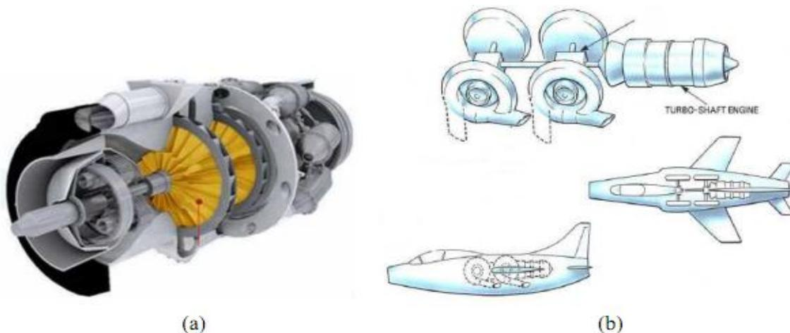
Figure (I.13) : Les compresseurs centrifuges en aéronautique [6].
