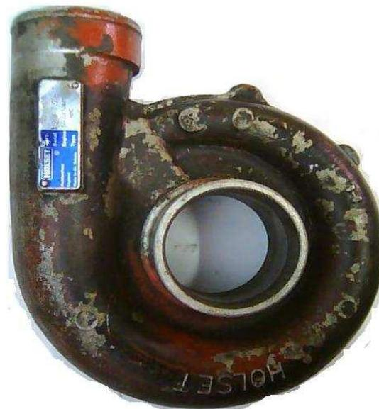
**Figure (I.9) :** La volute de compresseur centrifuge.
