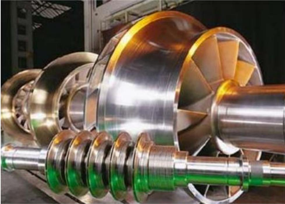
**Figure (I.5) :** compresseur centrifuge multi étage.
