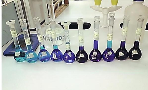
Figure II-10 : Les différentes solutions de la courbe d'étalonnage.
