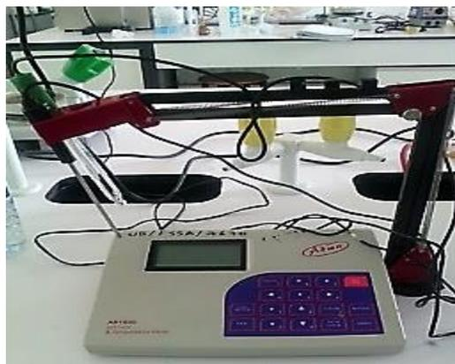
*Figure II-15 : Le pH-mètre utilisé.*
