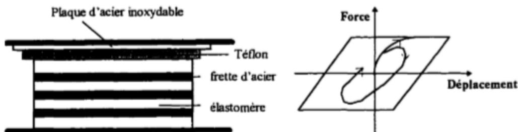
Figure I.4. Système EDF (Électricité de France) [7].
