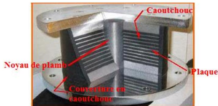
Figure I.3. Appui en barreau de plomb-type rond
