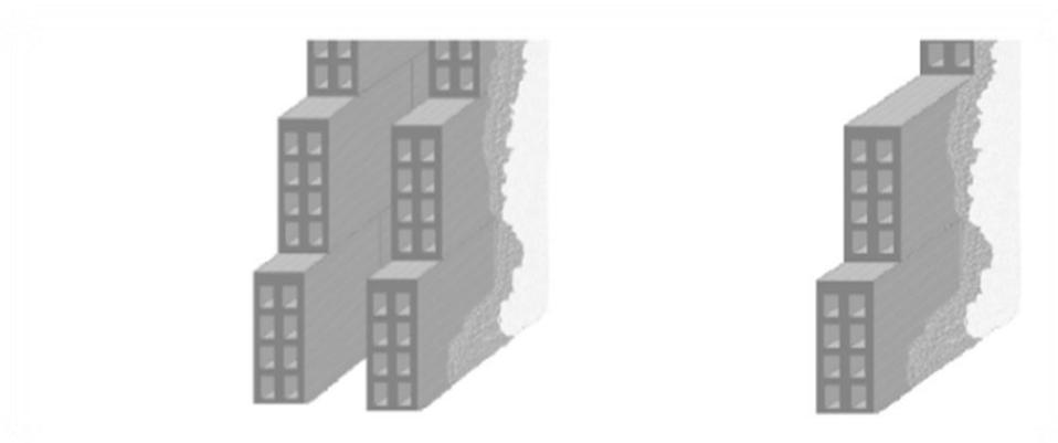
Figure II.8.Mur double cloison (gauche); Mur simple cloison (droite)
