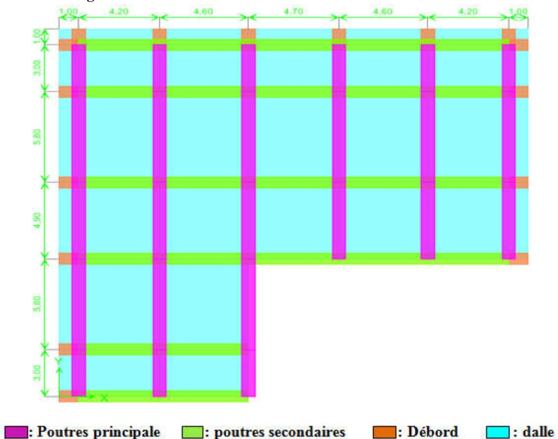
Figure VI.24: La vue en plan de radier nervuré «Bloc D»
