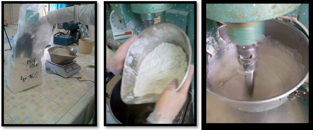
Figure IV.7. La confection des éprouvettes témoins
