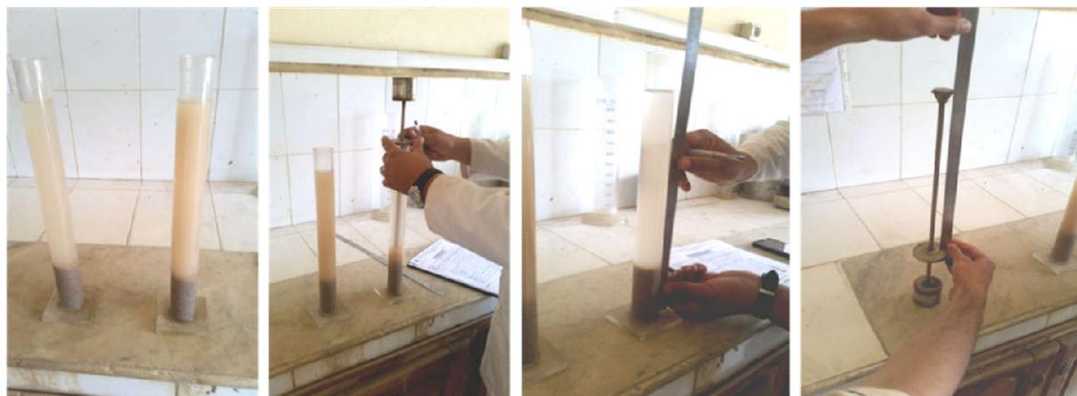
Figure .III. 3 : Essai d'équivalent de sable.
