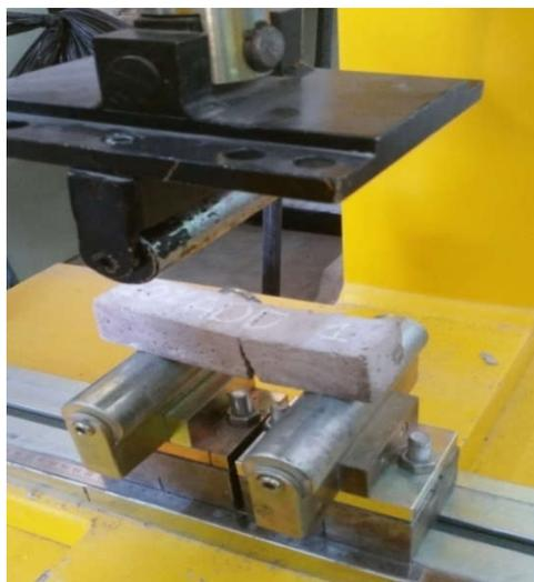
Figure .III. 12: Dispositif d'essai de flexion trois points.
