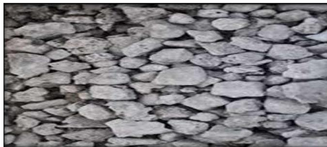
Figure .II. 8 : Laitier d'acier
