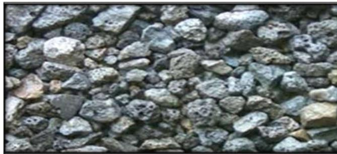
Figure .II. 7 : Laitier de haut fourneau
