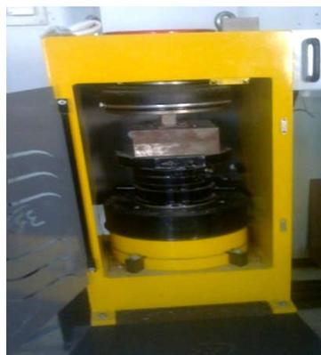
Figure .III. 14 : Machine d'essai à la compression.
