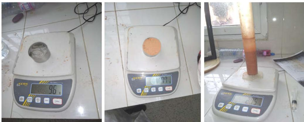
**Figure .III. 6 :** Essai de masse volumique de la poudre de brique.
