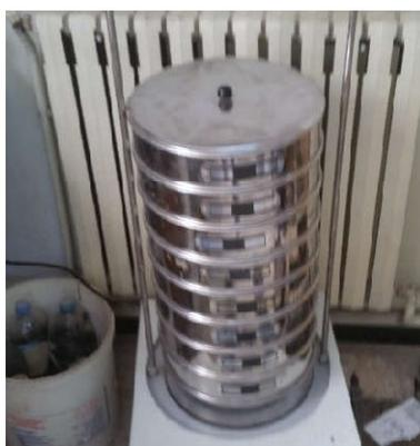
**Figure .III. 1:** Tamiseuse de laboratoire.
