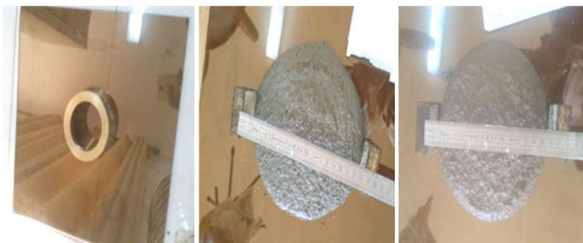
Figure .III. 9 : Essai d'étalement.
