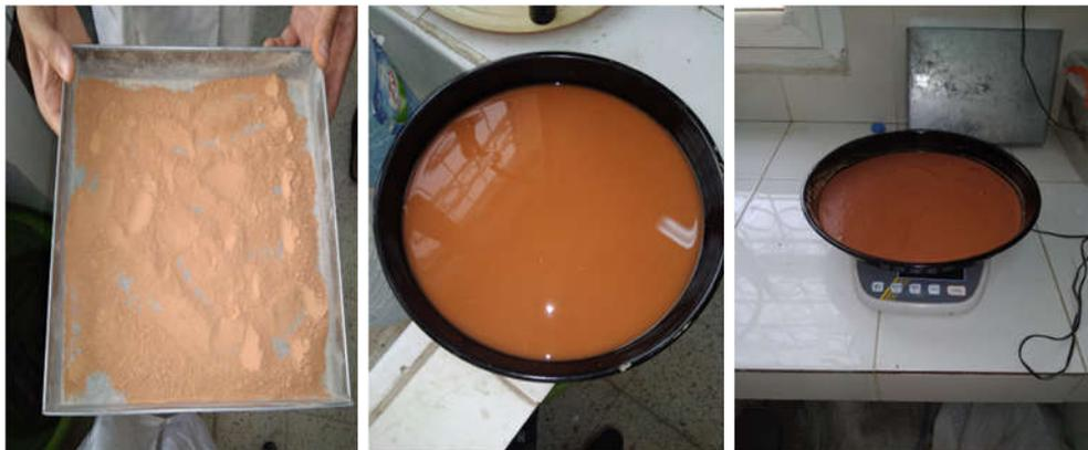
**Figure .III. 7:** Essai d'absorption d'eau.
