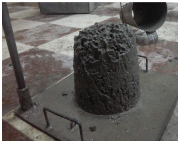
Figure II.9: Affaissement de cône d'Abrams.
