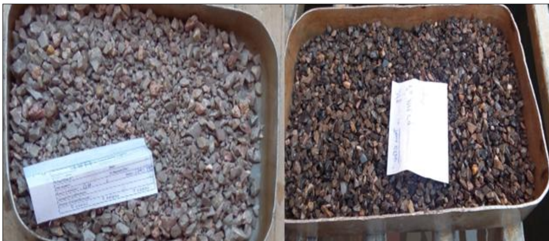
Figure II.3: Lavage des graviers pour l'essai de la propreté superficielle.
