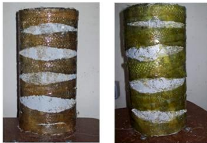
Figure I.33: Variation de la largeur de bande dans le confinement hélicoïdal. [15]
