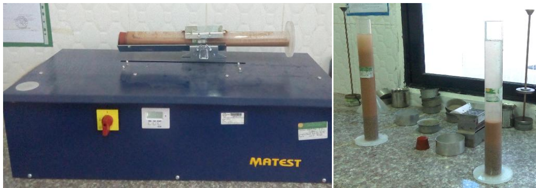
Figure II.5: Essai équivalent de sable.
