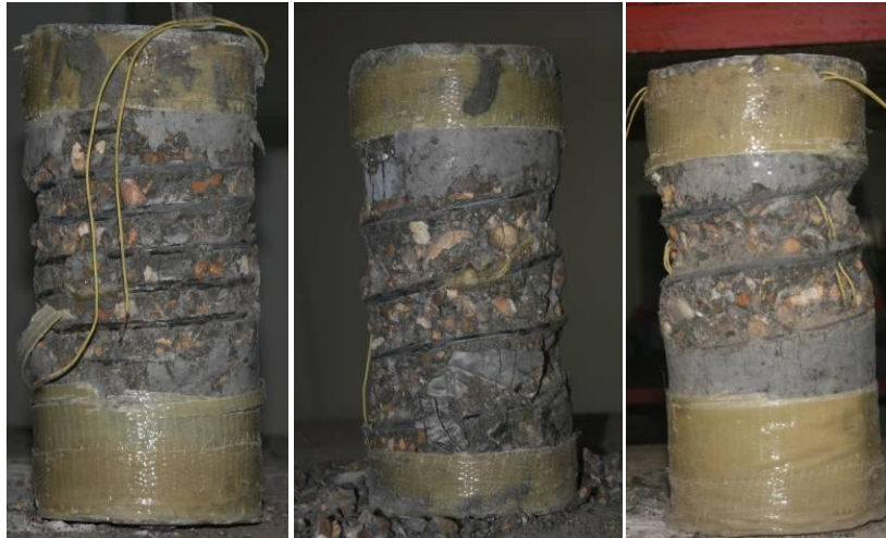
Figure I.31: Échec typique des spécimens. [19]
