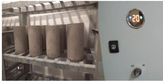
Figure II.14: Conservation des éprouvettes dans une chambre humide.
