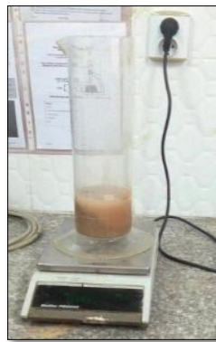
Figure II.7 : Mesure de la masse volumique absolue.
