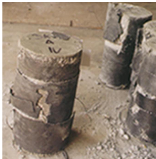
Figure I.29: Mode de rupture d'un cylindre enveloppé par des fibres de carbone. [18]
