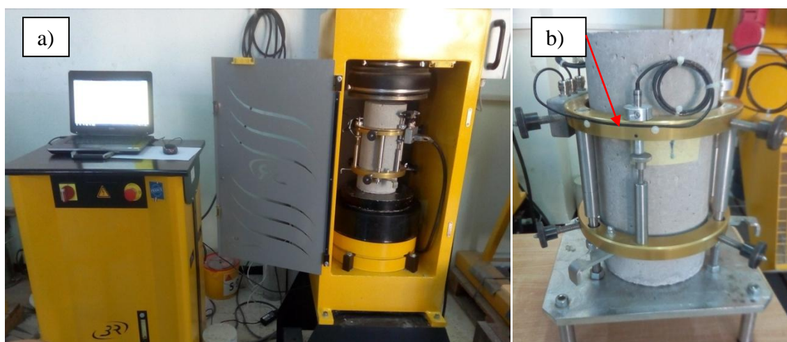
Figure III.1: Essai de compression : a) machine d'essai de compression b) système LVDT.
