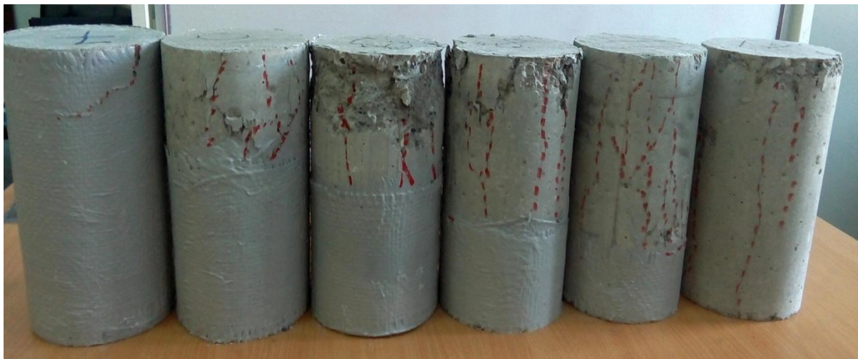
Figure III.14: Endommagement des spécimens.
