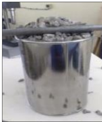
Figure II.6: Essai de masse volumique apparente.
