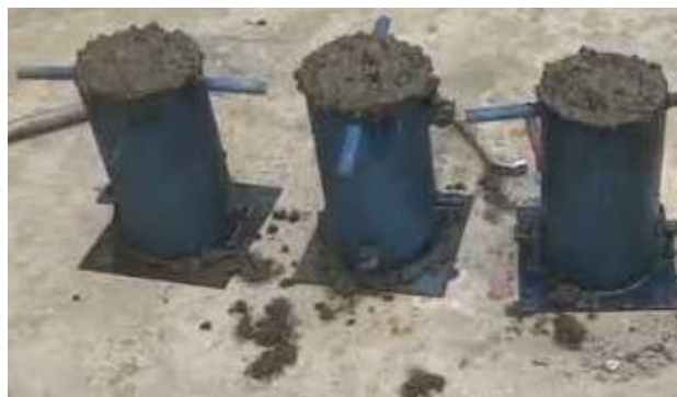
Figure II.12: Confection des éprouvettes.
