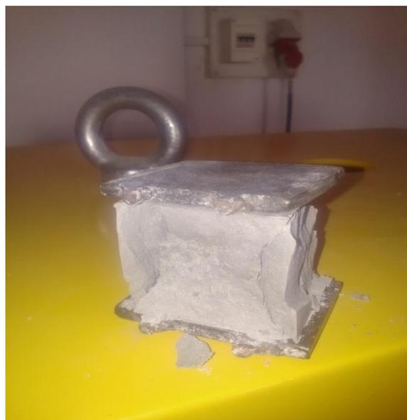
**Figure.34 : 2 Essai de résistance en compression**
