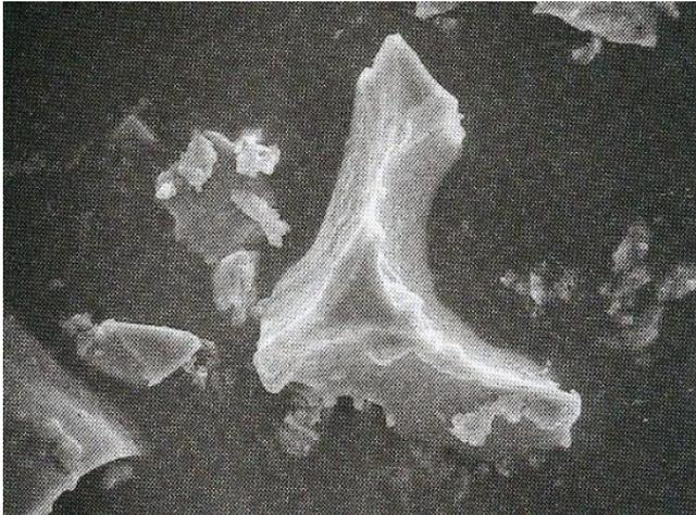
**Figure .11 : la forme anguleuse conduit à un dosage supérieur en eau [3]**
