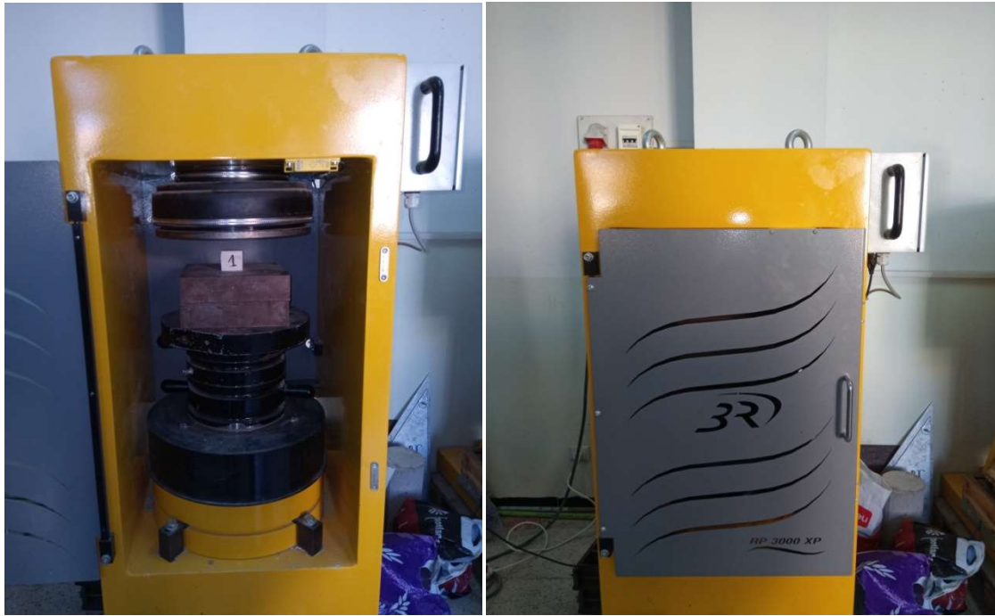
Figure IV. 7: Appareil d'essai compression.
