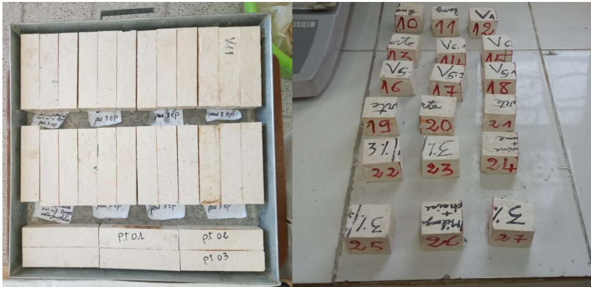
Figure IV. 4: Les éprouvettes réalisées ( 4 \times 4 \times 16 \text{ cm}^3 ) et ( 4 \times 4 \times 4 \text{ cm}^3 ).
