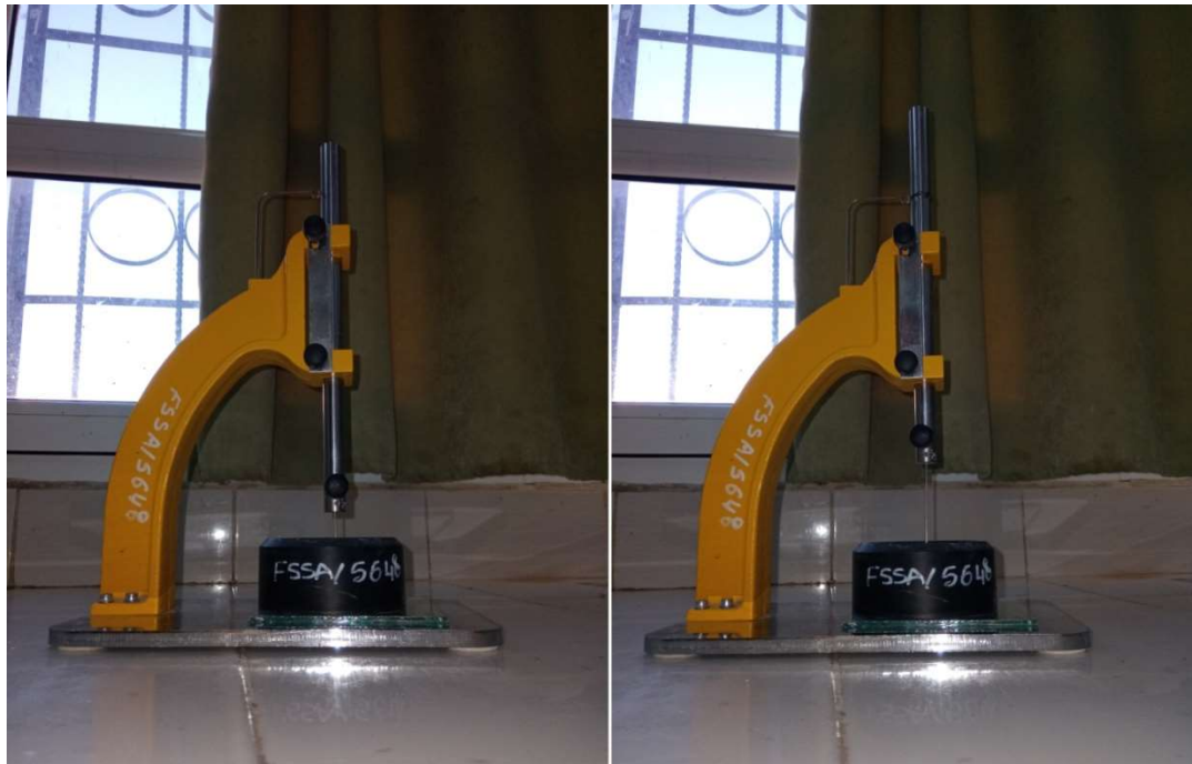
Figure IV. 2: Essai de prise avec l'appareil de Vicat.
