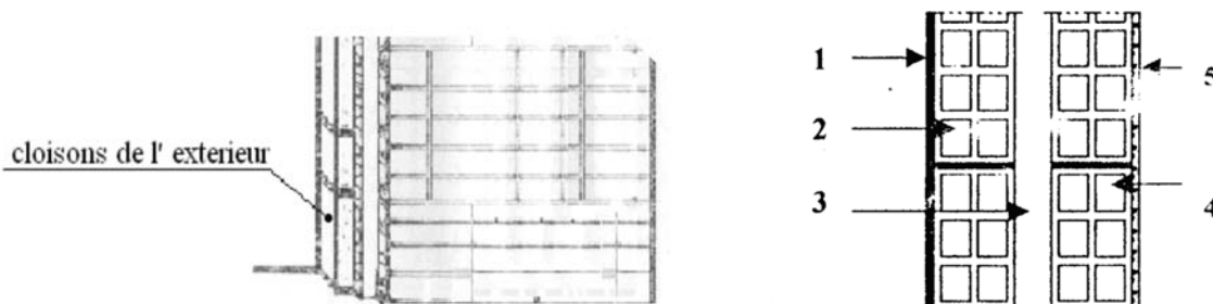
Figure. II.15. remplissage en double paroi.
