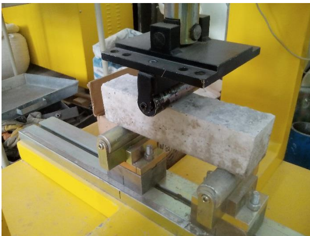
Figure IV.81: Essai mécaniques sur les éprouvettes de béton.
