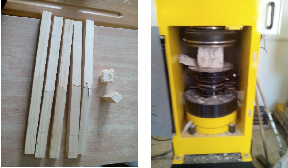
Figure IV.83: Rupture des éprouvettes bois et béton.
