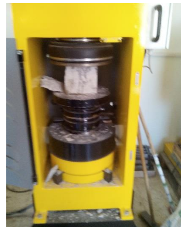
Figure IV.81: Essai mécaniques sur les éprouvettes de béton.
