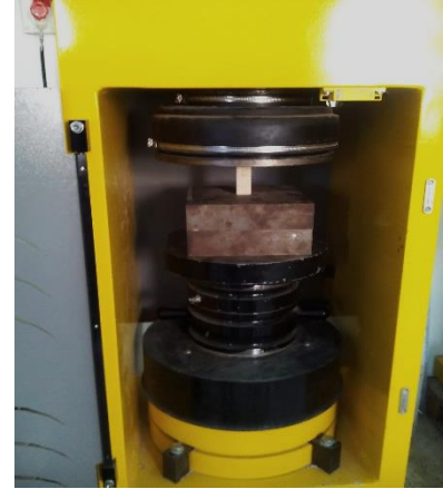
Figure IV.80: Essai mécaniques sur les éprouvettes de bois.
