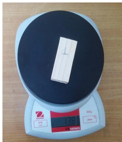
Figure IV.79: Essai de masse volumique des éprouvettes de bois.
