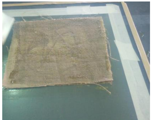
Figure 61. Pose de feuilles de tissu en jute
