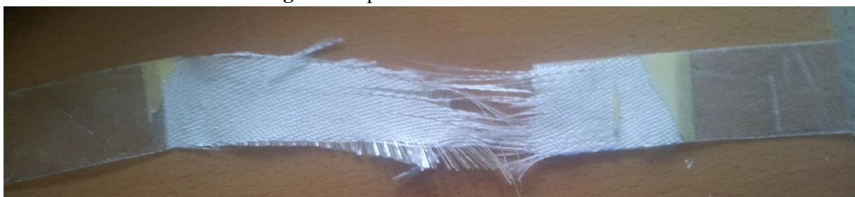
Figure 48. Rupture de fibre après essai de traction
