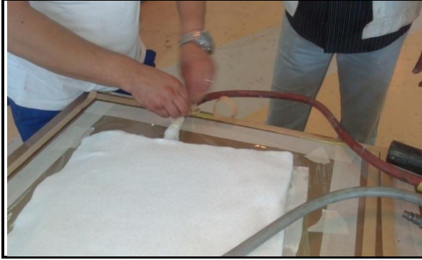
Figure 66. Mis en place le tuyau de pompage
