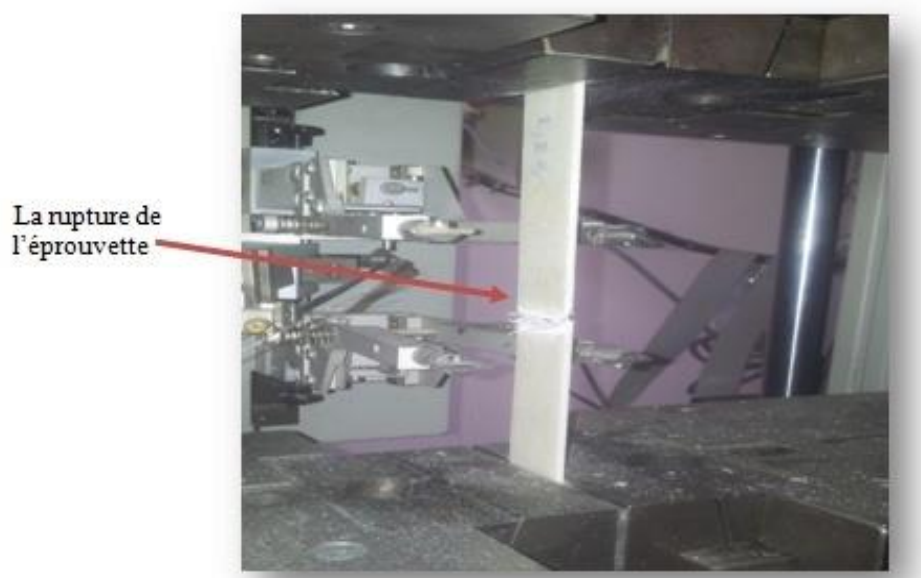
Figure 82. Rupture d'éprouvette après traction
