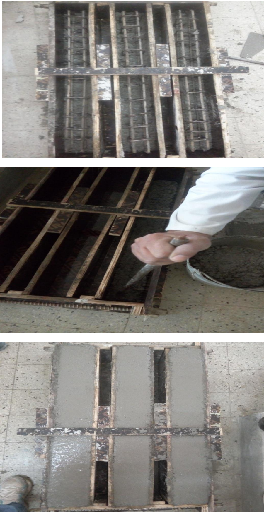
Figure .II.11. Les étapes de remplissage des moules
