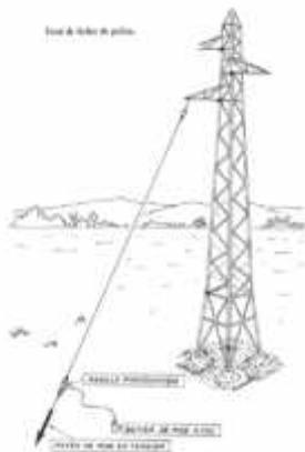
**Figure IV.4:** Essai par lâcher (Loung et al., 1992)
