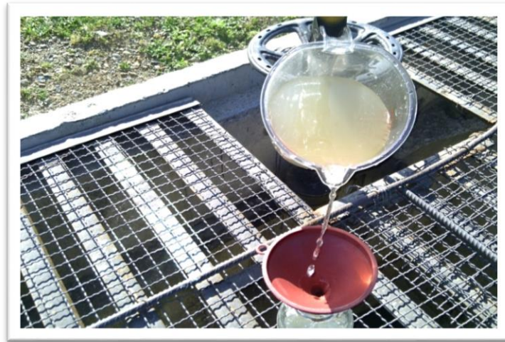
Figure 2 : Station de relevage n° 2-STEP de la ville de Bouira: Prélèvement d'eau usée
