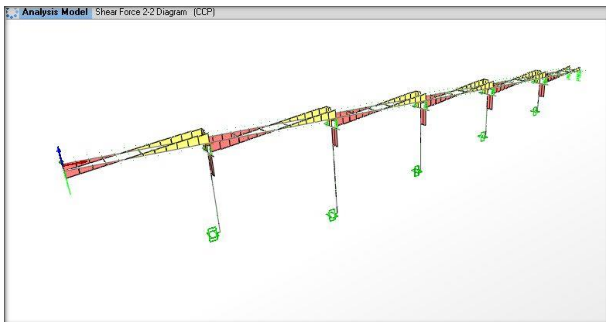
Figure 7.24 Diagramme des efforts tranchant sous charge CCP
