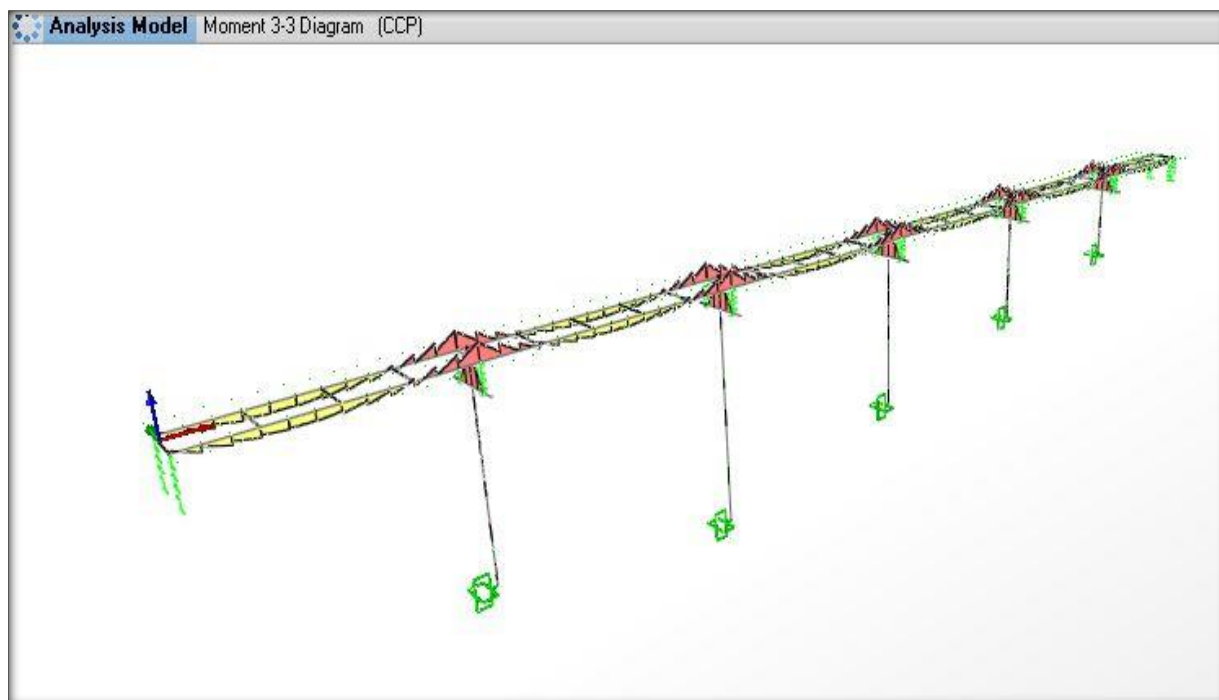
Figure 7.23 Diagramme des moments fléchissant sous charge CCP
