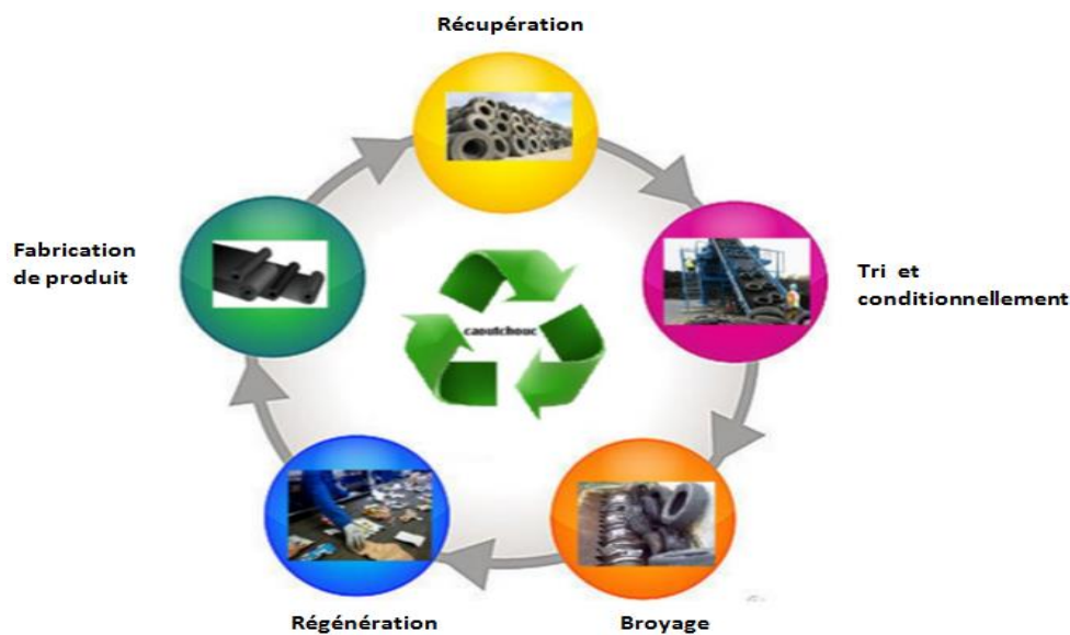
Figure III. 4: Processus de recyclage de déchets de caoutchouc [44].
