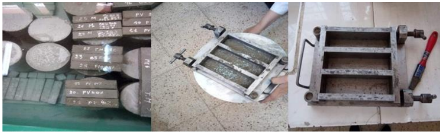
Figure VI. 12: Fabrication et conditionnement des éprouvettes.
