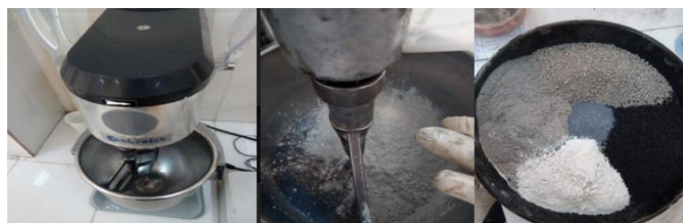
Figure VI. 11: Essai de malaxage des constituants de béton de sable avec déchets.
