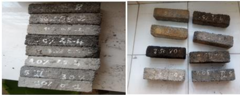
Figure VI.34 : Eprouvettes de béton de sable avant et après immersion dans l'acide HCl durant 28 jours.
