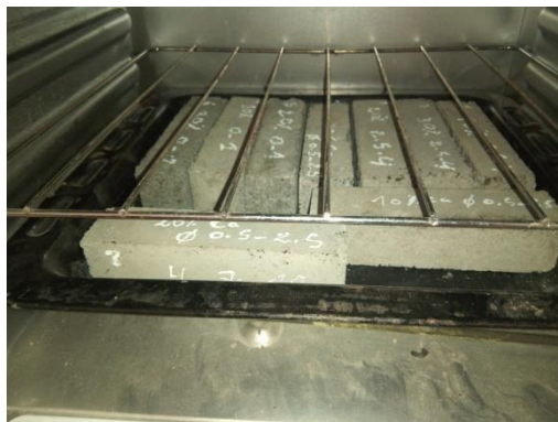
Figure VI.26 : Eprouvettes de béton de sable mise dans le four durant 24 heures à 100\text{ C}^\circ .
