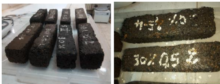
Figure VI.33 : Epreuves de béton de sable après immersion dans l'acide HCl durant 28 jours.
