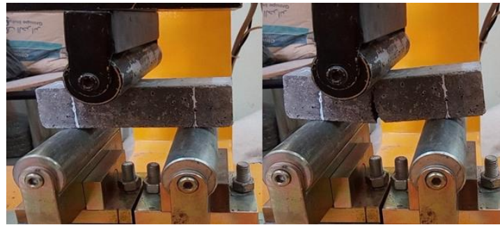
Figure VI. 15: Essai de flexion.
