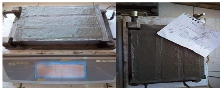
Figure VI. 13: La masse volumique a l'états frais des eprouvettes.
