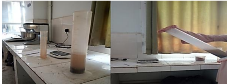
Figure VI. 1: Essai de la masse volumique absolue du sable (laboratoire Génie Civil).
