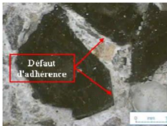
Figure III. 8: Défaut d'adhérence entre le caoutchouc et la matrice cimentaire vu au vidéo microscope, (grossissement x100) [49].
