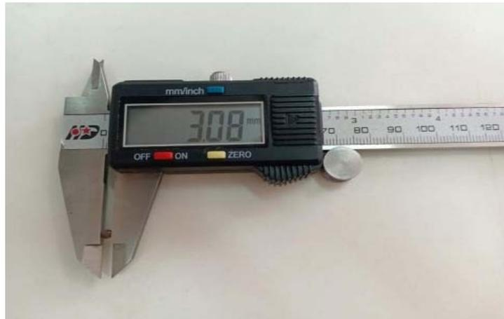
**Figure III. 5 :** Mesure des diamètres des billes à l'aide d'un pied à coulisse digital.
