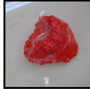
صورة رقم 92 : العينة الأولى داخل محلول H_2SO_4 .
