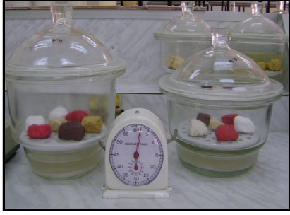
صورة رقم 89 : العينات في جهاز الرطوبة 75 % .
