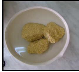
صورة رقم 64 : تبريد العينات قبل وزنها .
