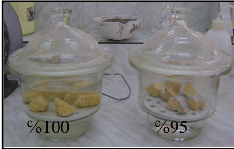
صورة رقم 82 : توضيح تأثير 95 % و 100 % من الرطوبة .
