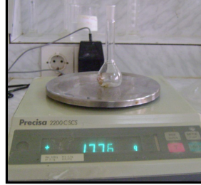
صورة رقم 72 : وزن البيكونومتر وهو فارغ .
