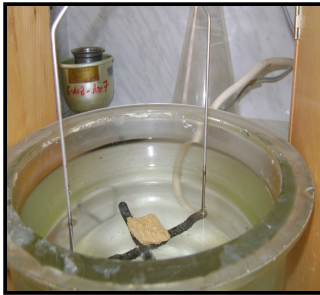
صورة رقم 68(ب): وزن العينة داخل الماء في ميزان هيدروستاتيكي .
