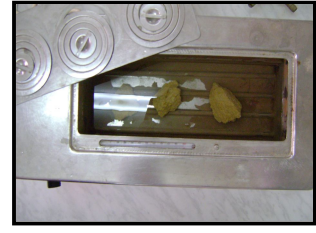
صورة رقم 63 : العينات داخل الحمام المائي .
