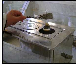
صورة رقم 75 : وضع العينات داخل الحمام المائي .
