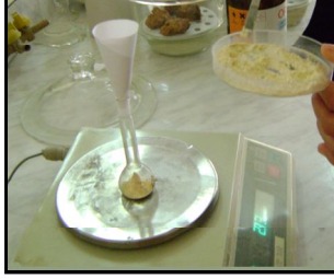
صورة رقم 73 : إضافة المسحوق إلى البيكونومتر .
