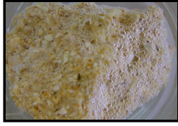
صورة رقم 94 : العينة الرابعة داخل محلول H_2SO_4 وتشكل الفقاعات .
