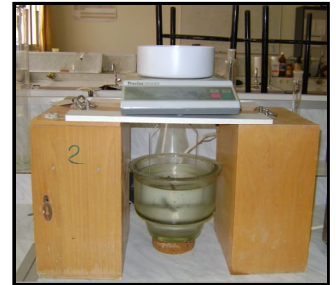
صورة رقم 67 : الميزان الهيدروستاتيكي المستعمل في التجربة .
