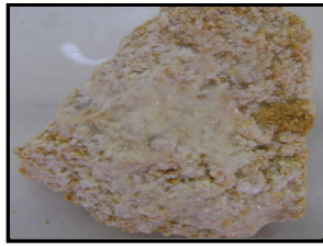
صورة رقم 100 : تشكل سطح أبيض وفقدان التماسك .
