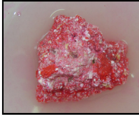
صورة رقم 97 : زوال أجزاء من الطلاء وتحلله ، وفقدان التماسك .
