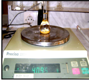
صورة رقم 76 : وزن المسحوق + التوليان .
