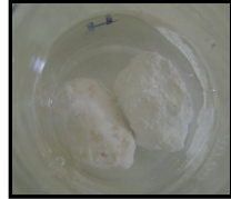
صورة رقم 93 : العينة 02 ، 03 داخل محلول H_2SO_4 .
