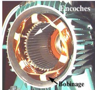
Fig. I.2. Stator (vue d'ensemble)
