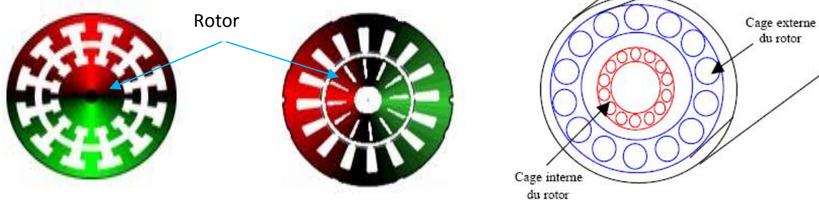
Fig. I.5- Rotor à cage simple. Fig. I.6- Rotor à cage profonde. Fig. I.7- Rotor à cage double.
