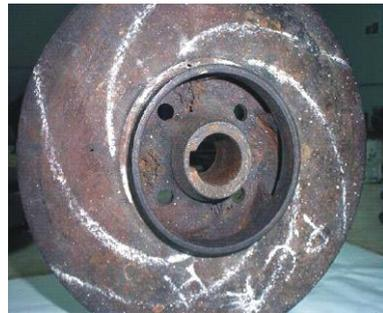
Roues fermées de la pompe centrifuge :  $D_2 = 230\text{mm}$ ,
