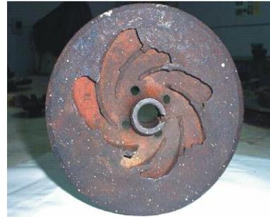
Roue fermée de la pompe multicellulaire immergée. Roue fermée de la pompe centrifuge
