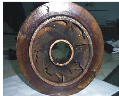
Roue fermée de la pompe centrifuge multicellulaire à axe horizontal en bronze
