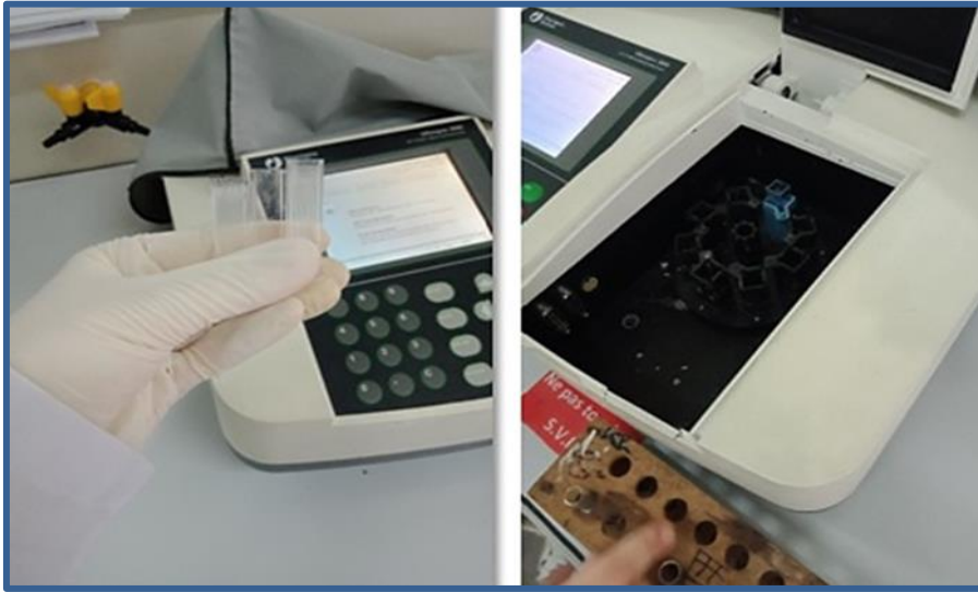
Figure 21 : Lecture de l'absorbance par spectrophotomètre pour le dosage des protéines (Photographie originale)
